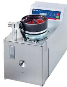
Der elektropneumatisch gesteuerten Abisolier- und Crimpautomat MC-40-1 dient zur rationellen Verarbeitung loser Aderendhülsen mit Kunststoffkragen. Das Abisolieren und Crimpen erfolgt in einem Arbeitsgang. Der MC-40-1 ist standardmässig mit Crimpwerkzeugen der Querschnitte 0.5 / 0.75 / 1.0 / 1.5 mm<sup>2</sup> mit 6-12 mm Hülsenlänge ausgerüstet. Für die Verarbeitung der Querschnitte 0.25 / 0.34 / 2.5 und 4 mm<sup>2</sup> gibt es entsprechende Erweiterungsätze.
