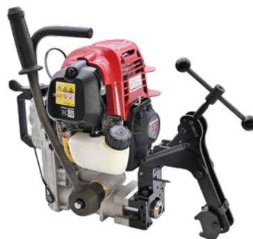
Die Schienenbohrmaschinen LD-4P entsprechen den sehr hohen Anforderungen im Gleisbau. Sie sind geeignet für das Bohren von Schienenkontakten wie auch für Achszähleranschlüsse. Antegrieben wird die Maschine von einem Honda 4-takt, Einzylinder Motor mit 47.9 cm<sup>3</sup> Hubraum.
