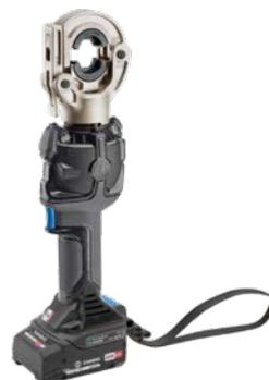
Die B600CND ist ein leistungsstarkes akkuhydraulisches Presswerkzeug für das Crimpen von grossen Kabelschuhen und Verbindern bis 300mm<sup>2</sup> konzipiert.
