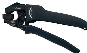
Janus, la crimpatrice più leggera e compatta del suo genere, è dotata di una serie di stampi rotanti in modo che i puntarelli possano essere inseriti nella parte anteriore o laterale dell'utensile per adattarsi al posto di lavoro. L'utensile è autoregolante e produce una forma di crimpaggio trapezoidale.
