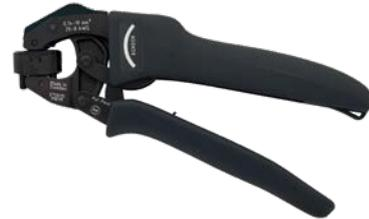
Janus, l'outil de sertissage le plus léger et le plus compact de ce type, dispose d'un jeu de matrices rotatives de sorte que les embouts peuvent être insérés à l'avant ou sur le côté de l'outil afin de s'adapter au lieu de travail. L'outil est auto-ajustable et produit un sertissage de forme trapézoïdale
