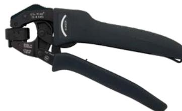
Janus ist ein kompaktes Crimpwerkzeug und verfügt über einen drehbaren Matrzensatz, so dass die Aderendhülsen an der Vorderseite oder an der Seite des Werkzeugs eingesetzt werden kann, je nachdem, wie im Schrank oder auf dem Tisch gearbeitet wird. Das Werkzeug ist selbstjustierend, erzeugt eine trapezförmige Crimpung.
