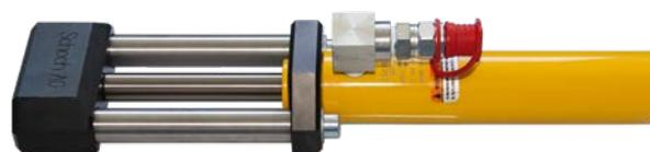
L'extracteur de clavette IBAV sert à ôter les clavettes de manière aisée et fiable sur les fixations internes des contre-aiguilles. Avec à la pompe hydraulique B70M-P36 l'extraction se fait rapidement et sans effort. La pompe fonctionne à une pression de service de 700 bar et arrive à ôter sans effort même les clavettes rouillées. Elle peut être commandée séparément.
