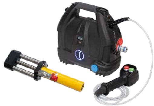
L'extracteur de clavette IBAV sert à ôter les clavettes de manière aisée et fiable sur les fixations internes des contre-aiguilles. L'extraction se fait rapidement et sans effort grâce à la pompe hydraulique B70M-P36. La pompe fonctionne à une pression de service de 700 bar et arrive à ôter sans effort même les clavettes rouillées.
