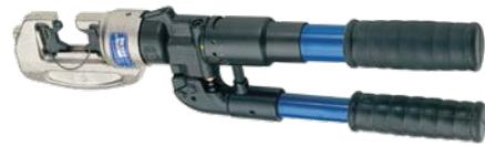
Die hydraulische Handpresse HT61 ist geeignet zum Verpressen von Verbindungsmaterial von 6 bis 240 mm<sup>2</sup>. Das Werkzeug ist mit einem Überdruckventil ausgestattet, das bei Erreichen des max. Druckes von 600 bar anspricht. Der Kopf ist um 180° drehbar. Durch die integrierte Doppelkolbenhydraulik wird ein sehr schnelles Arbeiten ermöglicht. Es steht eine umfangreiche Palette von Presseinsätzen zur Verfügung. Es können auch Zapfen-Presseinsätze Gr. 1 anderer Hersteller eingesetzt werden.
