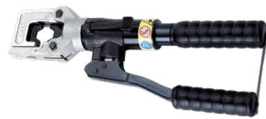
La presse manuelle hydraulique HT51 est parfaitement adaptée aux travaux dans des espaces très exigus. Le nouveau système hydraulique à double piston permet un sertissage rapide, même pour les sections les plus petites. La presse est facile d'utilisation grâce à sa tête rotative à 180°. Le système de décompression intégré peut être facilement actionné à tout moment.
