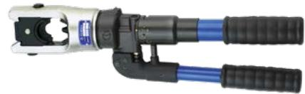
Die HT131-UC ist eine hydraulische Handpresse mit Doppelkolbenhydraulik, die ein schnelles Arbeiten gewährleistet. Der um 180° drehbare Kopf ermöglicht eine einfache Handhabung. Das integrierte Druckablasssystem kann zu jedem Zeitpunkt leicht betätigt werden.
