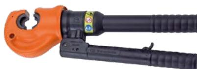
La HT120-KV est une presse manuelle hydraulique isolée. Grâce à sa tête rotative à 180°, il est facile d'utilisation. Le système de décompression intégré peut être facilement actionné à tout moment. Une gamme complète de matrices est disponible.
