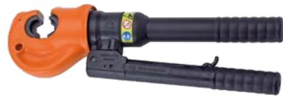
Die HT120-KV ist eine isolierte hydraulische Handpresse. Der um 180° drehbare Kopf ermöglicht einfache Handhabung. Das integrierte Druckablasssystem kann zu jedem Zeitpunkt leicht betätigt werden. Es steht eine umfangreiche Palette von Presseinsätzen zur Verfügung.
