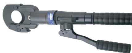
Le coupe-câble manuel hydraulique HT-TC051 est conçu pour couper des câbles avec un diamètre maximal de 50 mm (par ex 4 x 150 mm<sup>2</sup> NYY-0). La coupe particulière et la forme spéciale des lames garantissent une «coupe droite». Grâce à sa tête rotative à 90° et à son capuchon rabattable pratique, il est facile d'utilisation. L'outil est équipé d'un système hydraulique à double piston avec avancement rapide. Le système de décompression intégré peut être facilement actionné à tout moment.
