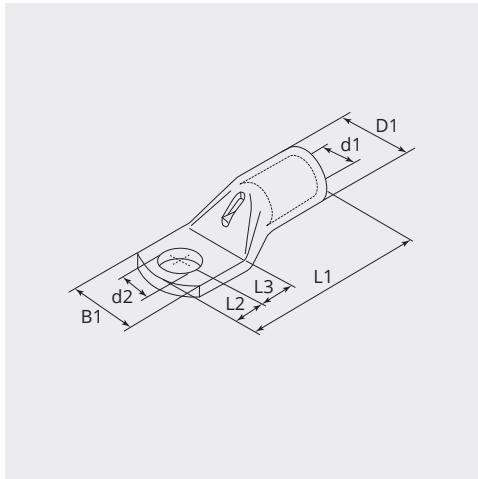
**DIMENSIONI****L1 (mm):** 56.0**L2 (mm):** 13.0**L3 (mm):** 13.0**B1 (mm):** 23.0**d1 (Ø):** 10.0**d2 (Ø):** 13.0**D1 (Ø):** 14**NOTA**
