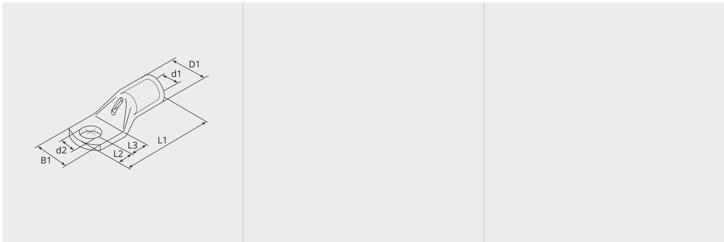
**DIMENSIONI****L1 (mm):** 114.0**L2 (mm):** 24.0**L3 (mm):** 24.0**B1 (mm):** 49.0**d1 (Ø):** 27.0**d2 (Ø):** 15.0**D1 (Ø):** 34**NOTA**
