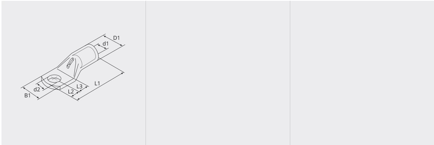
**DIMENSIONI****L1 (mm):** 44.0**L2 (mm):** 10.0**L3 (mm):** 10.0**B1 (mm):** 17.0**d1 (Ø):** 8.5**d2 (Ø):** 8.4**D1 (Ø):** 12**NOTA**
