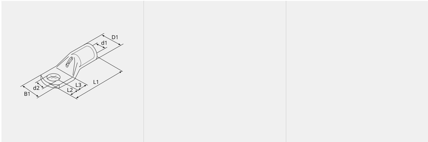
**DIMENSIONI****L1 (mm):** 22.5**L2 (mm):** 6.5**L3 (mm):** 6.5**B1 (mm):** 9.5**d1 (Ø):** 2.3**d2 (Ø):** 6.5**D1 (Ø):** 4.2**NOTA**
