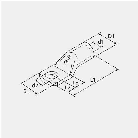
**DIMENSIONI****L1 (mm):** 83.0**L2 (mm):** 18.0**L3 (mm):** 18.0**B1 (mm):** 35.0**d1 (Ø):** 19.0**d2 (Ø):** 13.0**D1 (Ø):** 24**NOTA**
