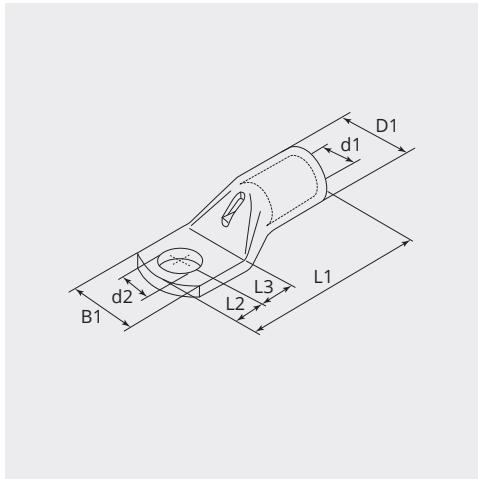
**DIMENSIONI****L1 (mm):** 83.0**L2 (mm):** 18.0**L3 (mm):** 18.0**B1 (mm):** 35.0**d1 (Ø):** 19.0**d2 (Ø):** 10.5**D1 (Ø):** 24**NOTA**
