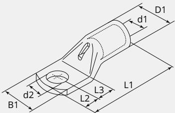
**DIMENSIONI****L1 (mm):** 41.5**L2 (mm):** 10.5**L3 (mm):** 11.5**B1 (mm):** 17.0**d1 (Ø):** 5.5**d2 (Ø):** 10.5**D1 (Ø):** 8.5**NOTA**
