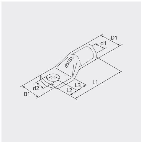
**DIMENSIONI****L1 (mm):** 88.0**L2 (mm):** 22.0**L3 (mm):** 22.0**B1 (mm):** 36.0**d1 (Ø):** 16.5**d2 (Ø):** 21.0**D1 (Ø):** 21**NOTA**
