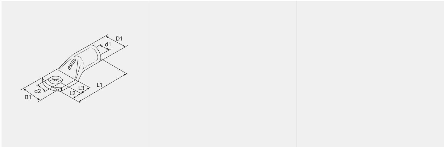
**DIMENSIONI****L1 (mm):** 65.0**L2 (mm):** 14.0**L3 (mm):** 14.0**B1 (mm):** 28.0**d1 (Ø):** 15.0**d2 (Ø):** 8.5**D1 (Ø):** 19.5**NOTA**
