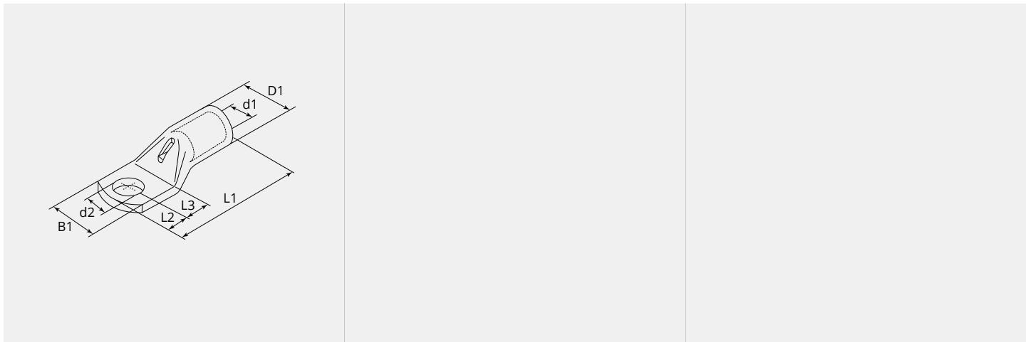
**DIMENSIONI****L1 (mm):** 65.0**L2 (mm):** 14.0**L3 (mm):** 14.0**B1 (mm):** 28.0**d1 (Ø):** 15.0**d2 (Ø):** 10.5**D1 (Ø):** 19.5**NOTA**
