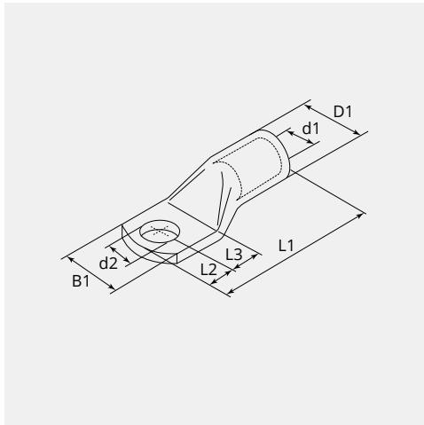
**DIMENSIONI****L1 (mm):** 51.0**L2 (mm):** 12.0**L3 (mm):** 12.0**B1 (mm):** 20.0**d1 (Ø):** 10.0**d2 (Ø):** 10.5**D1 (Ø):** 14**NOTA**
