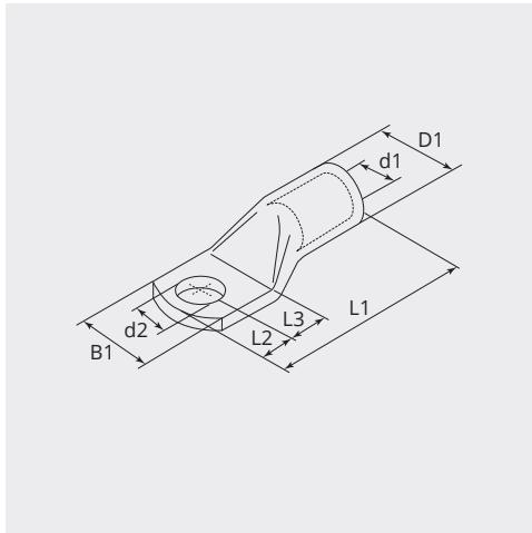
**DIMENSIONI****L1 (mm):** 114.0**L2 (mm):** 24.0**L3 (mm):** 24.0**B1 (mm):** 49.0**d1 (Ø):** 27.0**d2 (Ø):** 13.0**D1 (Ø):** 34**NOTA**
