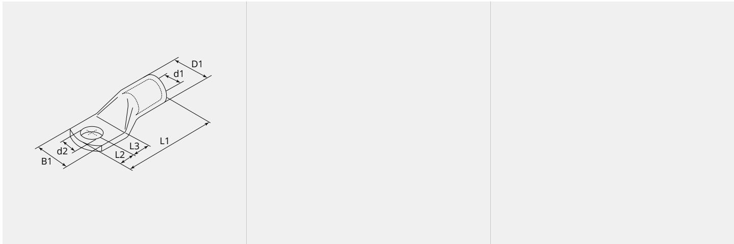
**DIMENSIONI****L1 (mm):** 54.5**L2 (mm):** 14.5**L3 (mm):** 14.5**B1 (mm):** 21.0**d1 (Ø):** 8.5**d2 (Ø):** 15.0**D1 (Ø):** 12**NOTA**
