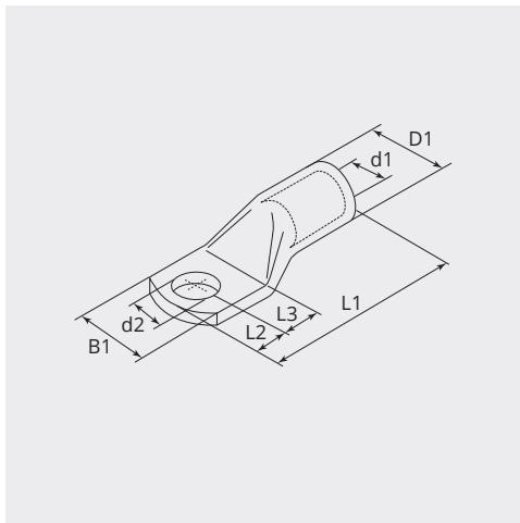
**DIMENSIONI****L1 (mm):** 111.0**L2 (mm):** 24.0**L3 (mm):** 24.0**B1 (mm):** 43.0**d1 (Ø):** 23.5**d2 (Ø):** 13.0**D1 (Ø):** 29.5**NOTA**
