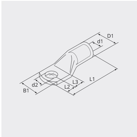
**DIMENSIONI****L1 (mm):** 42.0**L2 (mm):** 10.0**L3 (mm):** 10.0**B1 (mm):** 16.0**d1 (Ø):** 7.0**d2 (Ø):** 8.4**D1 (Ø):** 10**NOTA**
