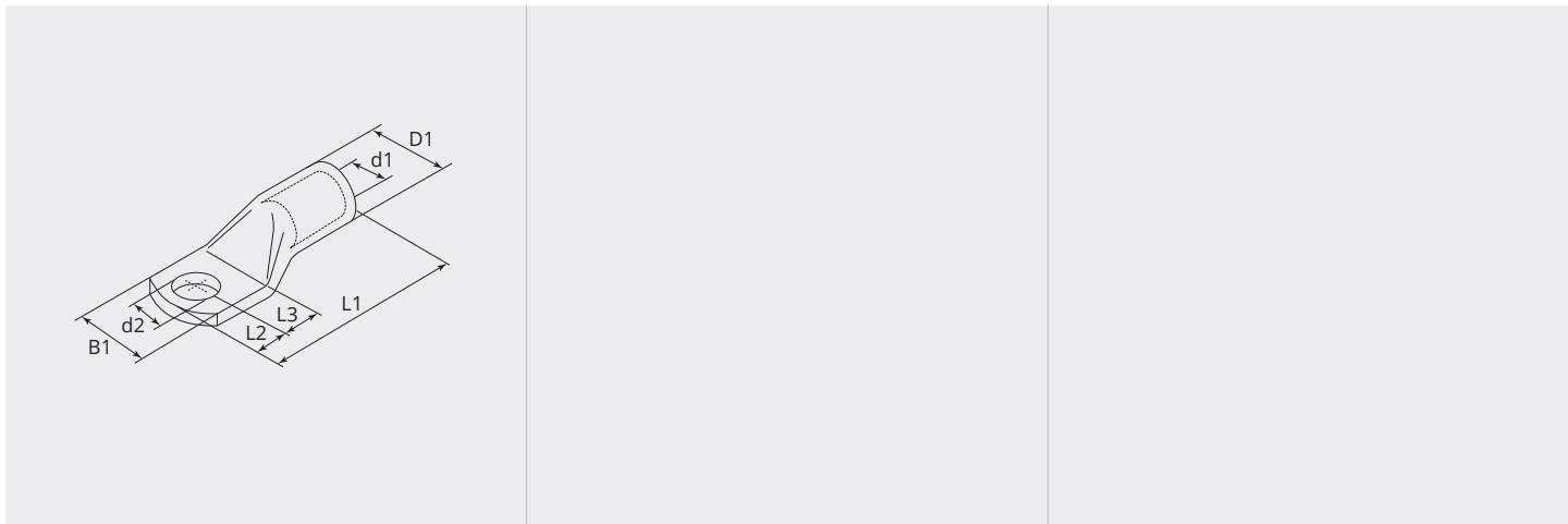
**DIMENSIONI****L1 (mm):** 37.5**L2 (mm):** 7.5**L3 (mm):** 7.5**B1 (mm):** 14.0**d1 (Ø):** 7.0**d2 (Ø):** 5.5**D1 (Ø):** 10**NOTA**
