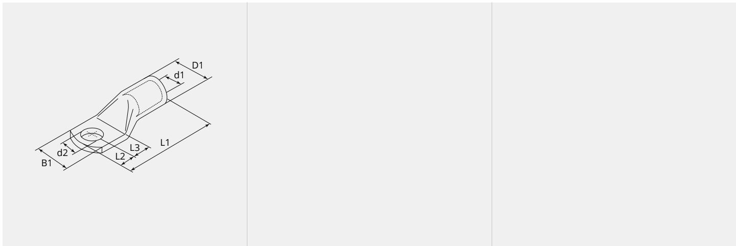
**DIMENSIONI****L1 (mm):** 17.0**L2 (mm):** 4.0**L3 (mm):** 5.0**B1 (mm):** 7.5**d1 (Ø):** 2.3**d2 (Ø):** 4.3**D1 (Ø):** 4.2**NOTA**
