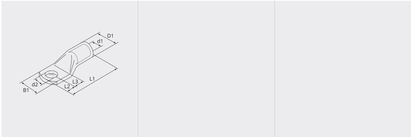
**DIMENSIONI****L1 (mm):** 83.0**L2 (mm):** 18.0**L3 (mm):** 18.0**B1 (mm):** 35.0**d1 (Ø):** 19.0**d2 (Ø):** 17.0**D1 (Ø):** 24**NOTA**
