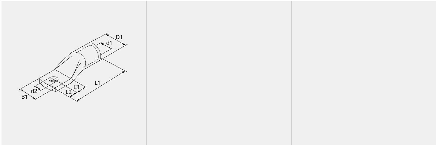
**DIMENSIONI****L1 (mm):** 67.5**L2 (mm):** 11.5**L3 (mm):** 14.0**B1 (mm):** 19.0**d1 (Ø):** 16.5**d2 (Ø):** 8.5**D1 (Ø):** 21**NOTA**
