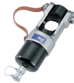
La tête de presse hydraulique ECW-H3D est équipée d'un accouplement rapide sans perte d'huile, qui permet le raccordement à une pompe hydraulique avec une pression de service maximale de 700 bar (voir pompes hydrauliques, à partir de la page 140). Les matrices correspondent à la taille 3 selon DIN 48083. Avec l'adaptateur AU230-130D, toutes les matrices des outils de 130 kN peuvent être utilisées.
