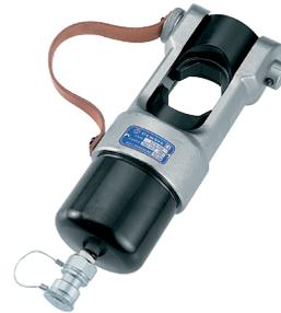
Der hydraulische Presskopf ECW-H3D ist mit einer ölverlustfreien Schnellkupplung ausgerüstet, die den Anschluss an eine Hydraulikpumpe mit einem maximalen Betriebsdruck von 700 bar ermöglicht (siehe hydraulische Pumpen, ab Seite 140). Die Presseinsätze entsprechen der Gr. 3 nach DIN 48083. Mit Hilfe des Adapters AU230-130D können auch alle Presseinsätze der 130-kN Werkzeuge verwendet werden.
