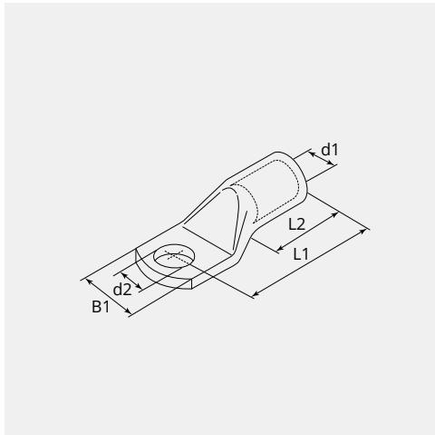
**DIMENSIONI****L1 (mm):** 39.0**L2 (mm):** 20.0**B1 (mm):** 14.6**d1 ( $\varnothing$ ):** 7.0**d2 ( $\varnothing$ ):** 6.4**NOTA**
