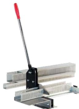
Per tagliare in modo rapido e preciso canali di cablaggio. Il DC-125 taglia i canali di cablaggio con angoli precisi e senza sbavature. Non è necessaria rilavorazione.
