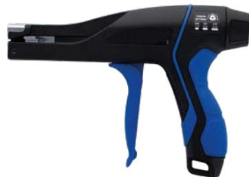
La technologie TLC (Tension/Lock/Cut) innovante et brevetée de CTG-48-OS a révolutionné l'utilisation de colliers de serrage en réduisant considérablement l'effort nécessaire pour les couper.- ouverture standard (90 mm)- forces de coupe réglables- pour colliers de serrage en plastique jusqu'à 4,8 mm de largeur- les colliers de serrage sont coupés proprement en une seule opération
