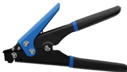
Chaque outil de la gamme CTG106-OS permet une coupe nette et droite des colliers de serrage et offre des forces de coupe élevées allant jusqu'à 175 lbf.- ouverture standard (110 mm)- forces de coupe de 40 N à 778 N- pour colliers de serrage de 3.6 jusqu'à 10.6 mm de largeur- les colliers de serrage sont coupés proprement en une seule opération
