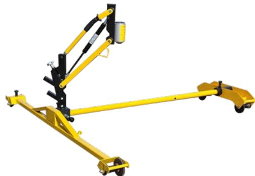
Ce chariot de roulement sur voie permet d'assister et de soulager l'opérateur utilisant la perceuse de traverse ou la boulonneuse tirefonneuse. Il est équipé de vérins à gaz qui donnent un contrôle constant et équilibré de la machine pendant son utilisation. Equipé des roues isolées, le chariot n'interfère pas avec les circuits électriques de la voie. Le chariot peut être aisément démonté et transporté par un seul opérateur.
