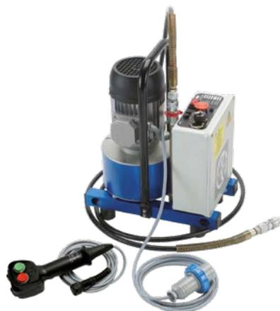
Die 220V-Elektro-Hydraulikpumpe CPE-1 arbeitet mit einem Einphasenmotor und einem maximalen Betriebsdruck von 700 bar. Die Steuerung der Pumpe erfolgt über die Handfernbedienung. An der Pumpe kann ebenfalls zu jedem Zeitpunkt der Druckabbau durch das Betätigen eines Tasters erfolgen. Es ist auch eine Ausführung für 110V verfügbar. Beide Ausführungen haben die Schutzart IP55.
