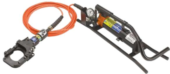
Nicht immer ist es möglich ein zu bearbeitendes Kabel mit absoluter Sicherheit zu identifizieren. Das eindeutige Feststellen der Spannungsfreiheit bereitet deshalb zum Teil auch grössere Schwierigkeiten. Um den Arbeitenden vor Gefahren zu schützen, arbeitet man deshalb mit Sicherheitsschneidanlagen, die dem hilfsweisen Feststellen der Spannungsfreiheit gemäss DIN VDE0105 T.1, Abschnitt 9.6.4 (07 83) dienen.
