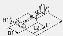
**DIMENSIONS****L1 (mm):** 19.0**L2 (mm):** 7.7**B1 (mm):** 6.3**Hauteur (mm):** 0.8
