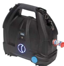
La pompa oleodinamico a batteria B70M-P36 presenta una batteria 36V – 8.0 Ah e funziona con una pressione di lavoro di 700 bar. La pompa può essere azionata con telecomando o pedale e sono dotate di un pulsante manuale per il funzionamento e lo scarico della pressione (bloccato elettronicamente per motivi di sicurezza quando viene utilizzato il telecomando a mano). Con una ricarica della batteria è possibile eseguire ad esempio fino a 90 tagli NAE-KEBY 3 x 150 mm.
