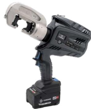
Il utensile di pressatura idraulica a batteria B600 presenta un dispositivo idraulico a due pistoni. La testa di pressatura è girevole di 180°, pertanto l'applicazione è possibile anche in luoghi stretti. È possibile utilizzare tutte le teste di pressatura secondo DIN 48083, in particolare quelle degli strumenti 68 kN (molla di apertura necessaria). È anche possibile utilizzare teste di pressatura a presa della misura 1 di altri produttori.
