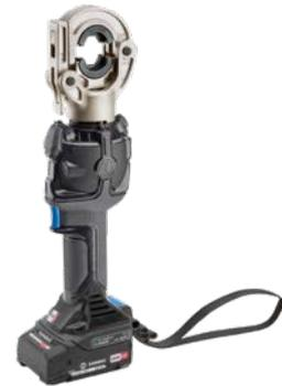
Die B600CND ist ein leistungsstarkes akkuhydraulisches Presswerkzeug für das Crimpen von grossen Kabelschuhen und Verbindern bis 300mm<sup>2</sup> konzipiert.
