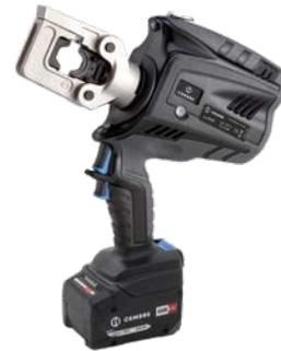
Die hydraulische Akkupresse B500 verfügt über eine Doppelkolbenhydraulik. Der Presskopf ist um 180° drehbar, dadurch wird der Einsatz auf engstem Raum möglich. Es können alle Presseinsätze nach DIN 48083 verwendet werden, insbesondere die der 63 kN Werkzeuge.
