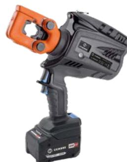
Die isolierte hydraulische Akkupresse B500-KV verfügt über eine Doppelkolbenhydraulik. Der Presskopf ist um 180° drehbar, dadurch wird der Einsatz auf engstem Raum möglich. Es können alle Presseinsätze nach DIN 48083 verwendet werden, insbesondere die der 63 kN Werkzeuge.
