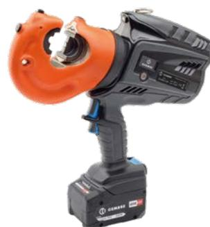
La presse hydraulique isolée sur batterie B1350-C-KV dispose d'un système hydraulique à double piston. Grâce à sa tête de presse rotative à 180°, elle peut être utilisée dans des espaces très exigus.
