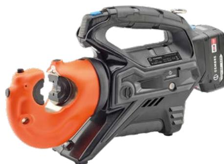
Il utensile di pressatura oleodinamico isolato a batteria B1300-C-KV presenta un dispositivo idraulico a due pistoni. La testa di pressatura è girevole di 180°, pertanto l'applicazione è possibile anche in luoghi stretti. Un chip controlla la modalità di lavoro e spegne automaticamente il motore non appena è realizzata la pressatura. Questo consente di risparmiare energia e di aumentare la durata della batteria.
